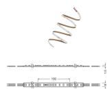
Technische Daten Ledvance LED-Streifen Value 1500 60W 5640lm 24v - 827 | 5M/8mm
